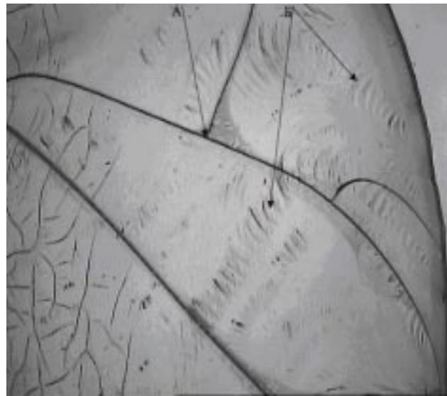
Рис. 3. Трещины, параллельные краю и расположенные под углом (указаны стрелками А) и морщины в периферической зоне фации (указаны стрелками Б). × 40.
